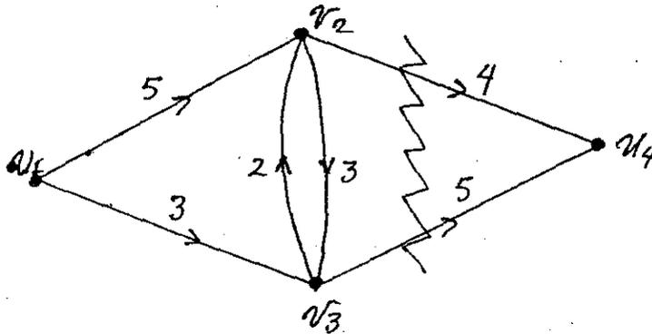
$$K(V_I, V_4) = K(v_1, v_4) + K(v_2, v_4) + K(v_3, v_4) = 9$$
