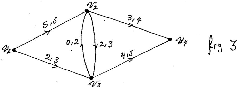
CORTE DE UNA RED.-UN CORTE DE UNA RED  $(V, K)$  CON RESPECTO A LOS VERTICES  $v_1$  Y  $v_n$  (FUENTE Y SUMIDERO) ES UNA PARTICION DEL CONJ.  $V$  EN DOS CONJS.  $V_L$  Y  $V_n$  TALES QUE  $v_1 \in V_L$  Y  $v_n \in V_n$ . LA CAPACIDAD DEL CORTE  $(V_L, V_n)$  ES EL NUMERO
