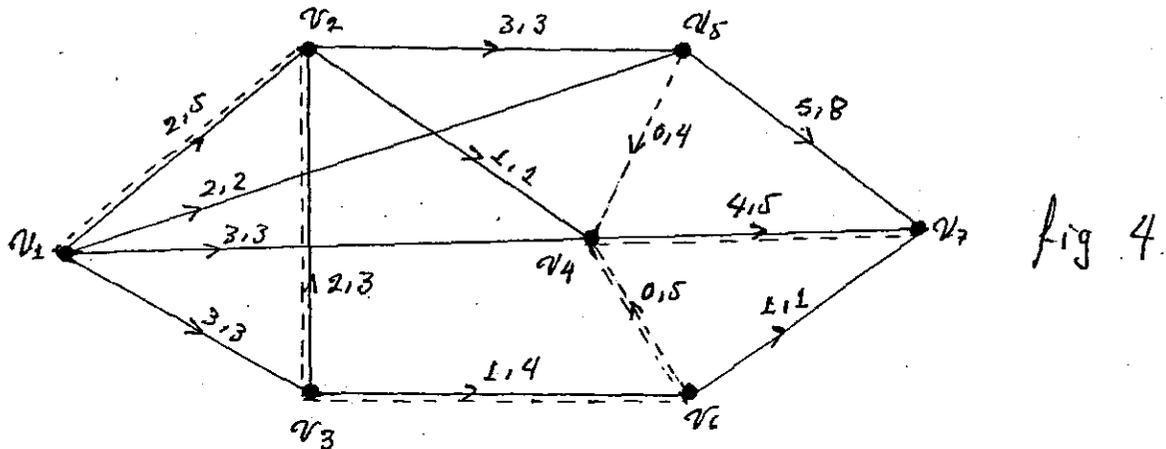
$v_1 \rightarrow v_2 \rightarrow v_3 \rightarrow v_6 \rightarrow v_4 \rightarrow v_7$  ES UNA CADENA AUMENTADORA DE  $v_1$  A  $v_7$  (FUENTE Y SUMIDERO) TAL QUE  $\{v_2, v_3\}$  POSEE EL ARCO  $(v_3, v_2)$  YA QUE  $f(v_3, v_2) = 2 \neq 0$ , Y LOS LADOS RESTANTES  $\{v_i, v_j\}$  POSEEN  $(v_i, v_j)$  YA QUE SON NO SATURADOS:
